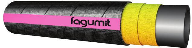
• elastyczny wąż stosowany w instalacjach samochodowych do przepływu paliw ropopochodnych o zawartości węglowodorów aromatycznych do 50%, w tym również bioetanolu (związki tlenowe do max 15%) oraz biodiesla (80% oleju napędowego i 20% biokomponentów - estrów) • temp. pracy: od -30°C do +100°C, okresowo +125°C • warstwa wew.: gumowa, NBR, czarna, gładka • wzmocnienie: tekstylne • warstwa zew.: gumowa, NBR/PCV, czarna, odporna na czynniki atmosferyczne i wysoką temperaturę
